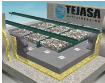
5- Posar 2 UPN 160 de acero para desplazar el transformador, y 2 UPN 160 de acero para prolongar el movimiento de los transformadores.
