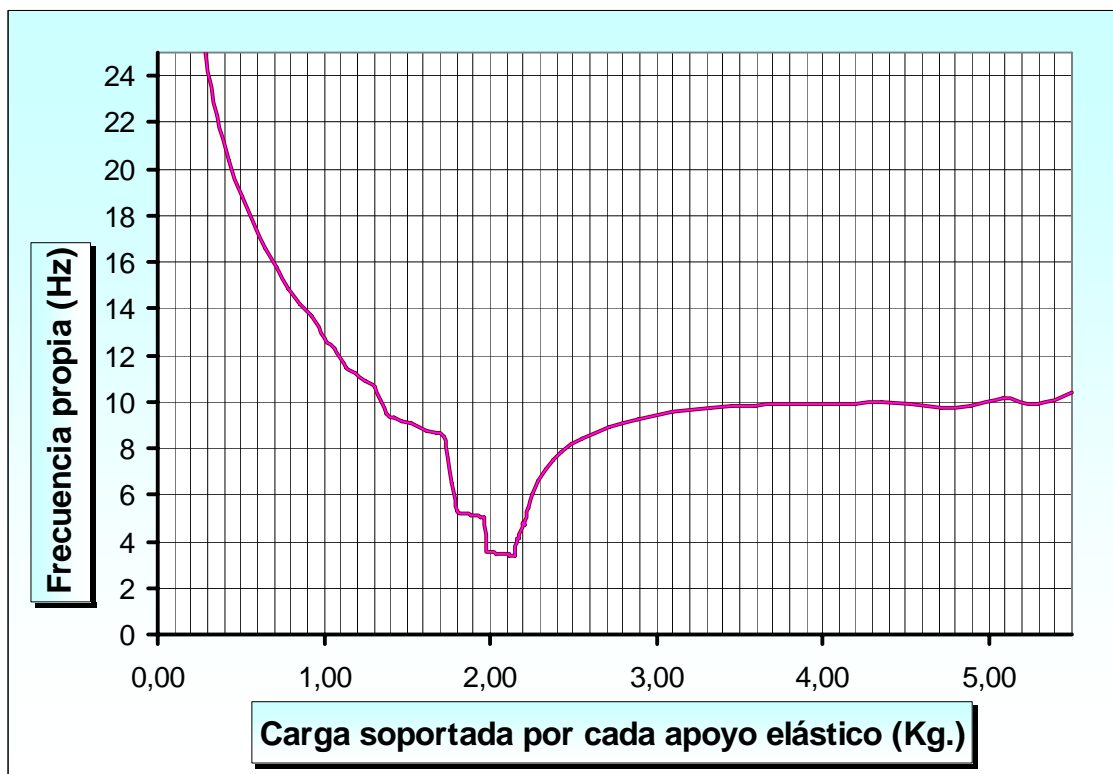
Frecuencia de resonancia en función de la carga soportada por apoyo Ref. 969002-1
